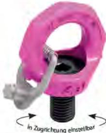
Für die werkzeuglose Montage wird die Starpoint-Ringschraube mit einem vergrüteten Montageschlüssel geliefert (Typ VR.SF). Ganz einfach: Montageschlüssel in Innensechskant einrasten - fertig! Ein- und Ausdrehen von Hand möglich. Dann ausrasten: VRS ist drehbar! Durch die Einstellung in Krafrichtung wird das unbeabsichtigte Aufdrehen oder Überdrehen der Ringschraube verhindert.
