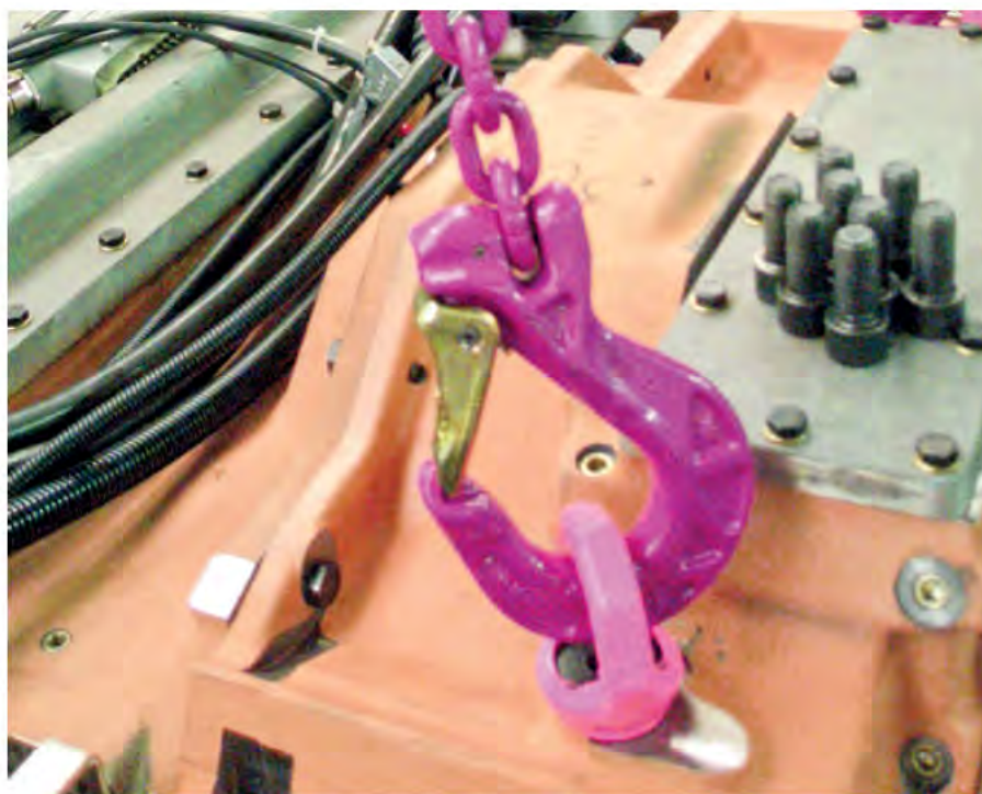
ICE-Anschlagkette, 1-Strang, verkürzt mit Verkürzungshaken IVH und Sicherheitshaken ISH
